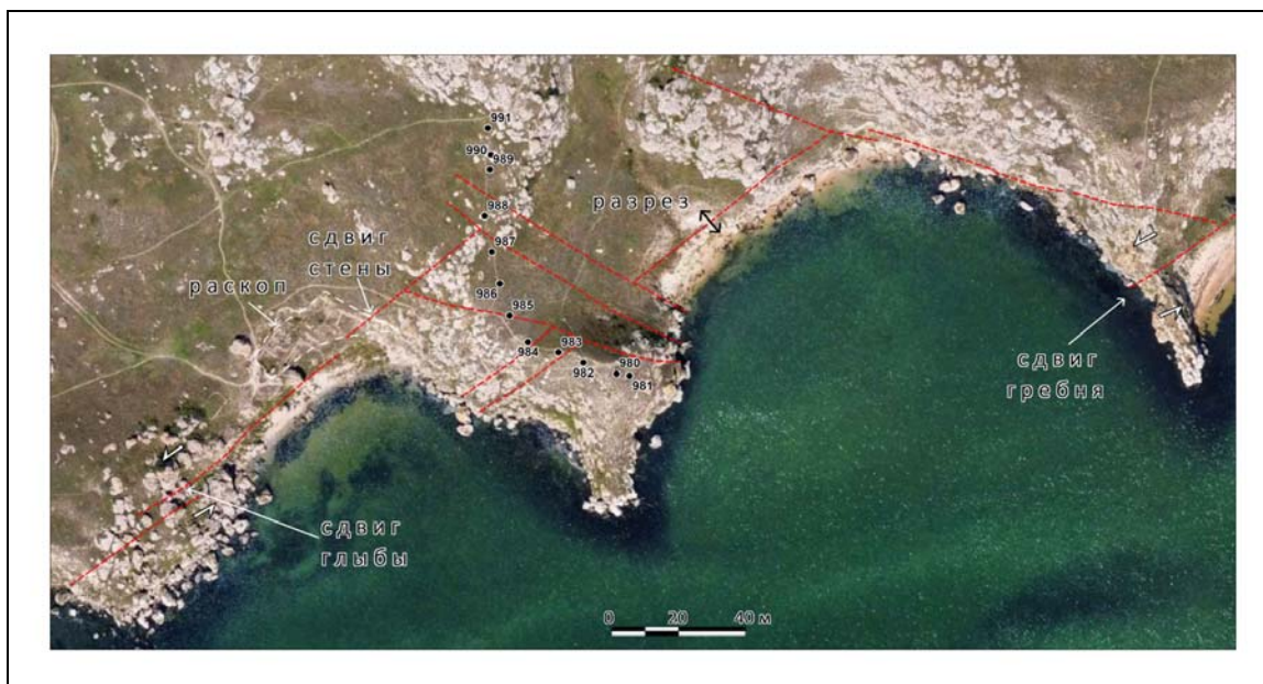
Рис. 13. Общий вид района городища с тектоническими разрывами (красные линии), точками георадарного профиля и положением выявленных сейсмотектонических смещений. Фотоплан 2021 г.
